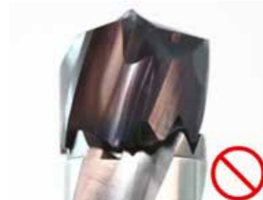
Talaş kanalları ve ağızlar birbirini tutmuyor
