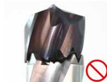
Drážky pre odvod triesok a ozubenia nesedí správne
