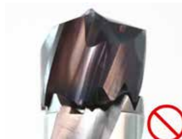
Drážky pro odvod třísek a ozubení nesedí správně
